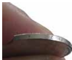
'Duivelshap' (1 gulden 1980), hap uit muntplaatje, veroorzaakt tijdens het uitstansen van de rondellen. Hierdoor is 'GOD' uit het randschrift verdwenen, de tekst luidt dus '* ZIJ * MET * ONS *'. Het is een originele misslag met terugwijkende randen (tapering). Ook is een 2½ gulden 1980 met '* G * ZIJ * MET * ONS *' bekend
