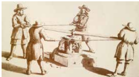
Daniël de Blicck, De schroefpers in werking . 35 x 22 cm, oost-indische inkt op papier, (Zeelandia Illustrata, ZI 3 1027-1029)
