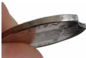
'Duivelshap' (1 gulden 1980), hap uit muntplaatje, veroorzaakt tijdens het uitstansen van de rondellen. Hierdoor is 'GOD' uit het randschrift verdwenen, de tekst luidt dus '* ZIJ * MET * ONS *'. Het is een originele misslag met terugwijkende randen (tapering). Ook is een 2½ gulden 1980 met '* G * ZIJ * MET * ONS *' bekend
