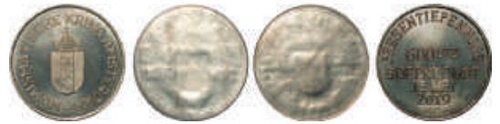
Experiment: resultaat van een slag met twee rondellen op elkaar
